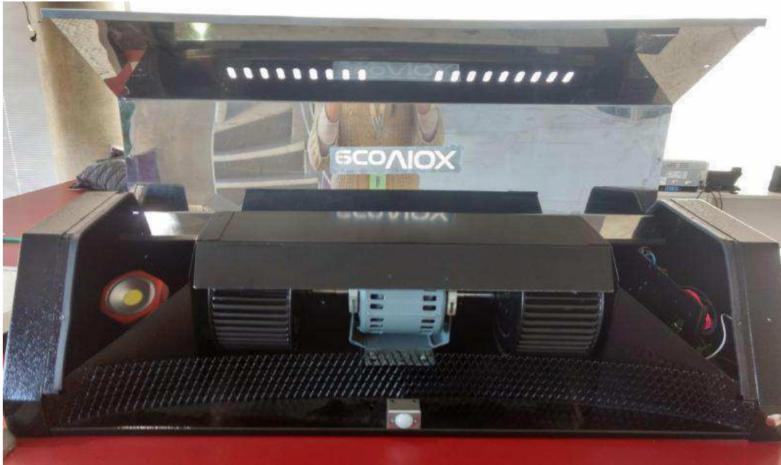
Figura 4: Equipo abierto. Zona donde está el motor y el integrador de luz
